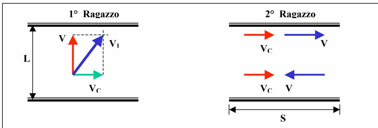
Il primo ragazzo si muoverà con una velocità effettiva  $V_1$  che è la risultante tra le velocità  $V$  e  $V_C$ , il cui modulo e argomento è dato da:
