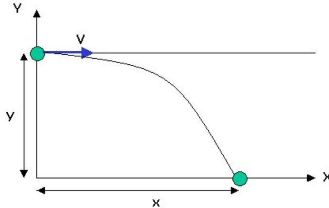
Il moto del pacco è un moto parabolico, che è un moto risultante di un moto uniformemente accelerato e di un moto rettilineo uniforme:
