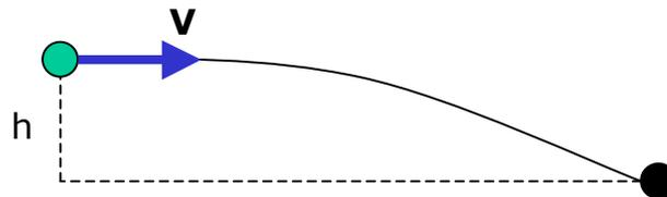
Il moto del proiettile è un moto parabolico, che è un moto risultante di un moto uniformemente accelerato e di un moto rettilineo uniforme:
