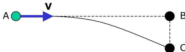
Il moto del proiettile è un moto parabolico, che è un moto risultante di un moto uniformemente accelerato e di un moto rettilineo uniforme:
